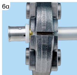
6a Pressbacke mit der breiten Nut am Kunststoffing des Fittings aufsetzen
