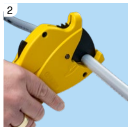
2 Ablängen des Rohres
