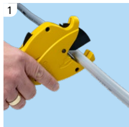
1 Schneidgerät rechtwinklig anlegen
