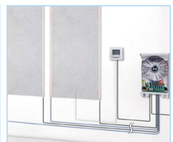
Verdrähten des Netzteils mit den Kabeln und Raumthermostat
